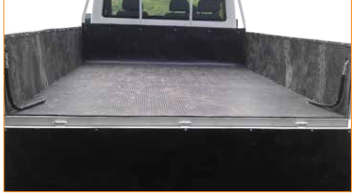
▶ Araç taban ve kapak lastikleri kamyonete uygulama örneği
